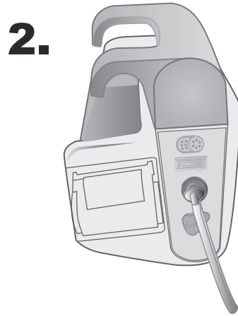
Şekil 8-1 X Series Advanced Ünitesine Çift Lümenli Hortum Takma
