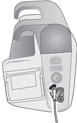
Şekil 9-1 Örneklem Hattı Konektörünü CO 2 Giriş Portuna Bağlama
